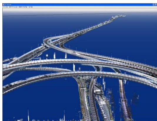
Exemple 2 : mesure d'échangeurs 3D avec un scanner laser standard et une superposition d'images caméra en couleur
