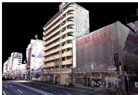
Exemple 4 : mesure détaillée de l'apparence des bâtiments avec un scanner laser longue distance ou haute densité disponible en option
