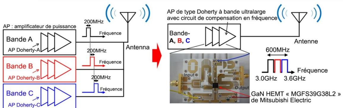
Amplificateurs de puissance dans les stations de base pour la nouvelle génération de systèmes sans fil
