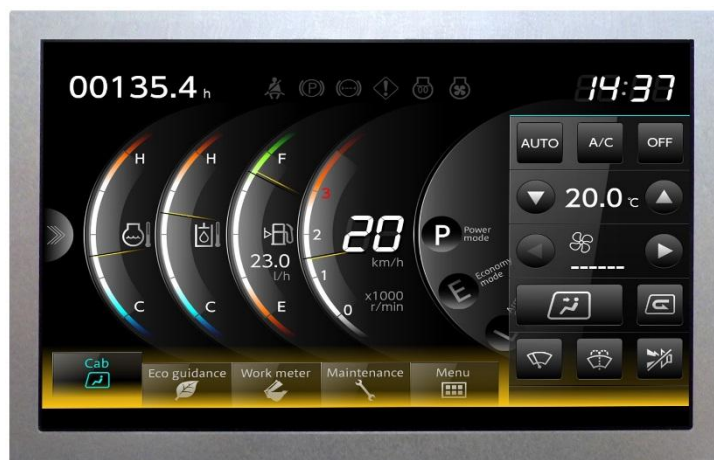
Module LCD TFT couleur Tough Series Mitsubishi Electric AT070MP11
