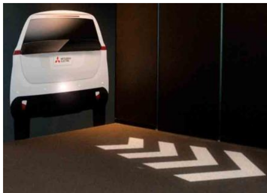
Indicateur de marche arrière avec signal lumineux projeté sur le sol
