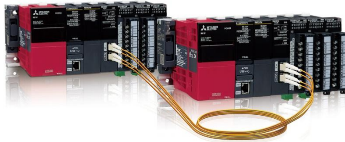
Automate programmable redondant série MELSEC iQ-R conforme au SIL 2
