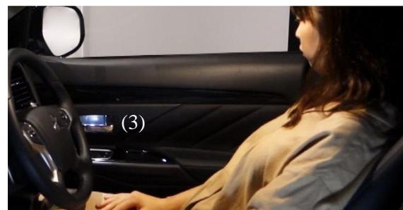
Trois types d'illuminations animées (1, 2 et 3) changent lorsque les capteurs détectent des piétons à proximité
