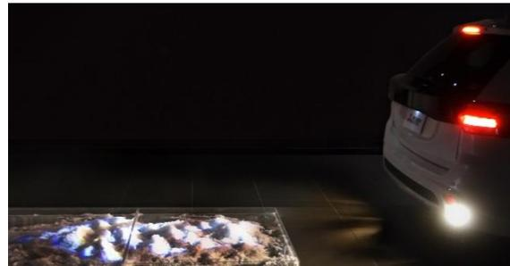
Projetées sur la surface de la route, les illuminations animées sont facilement visibles, même par mauvais temps
