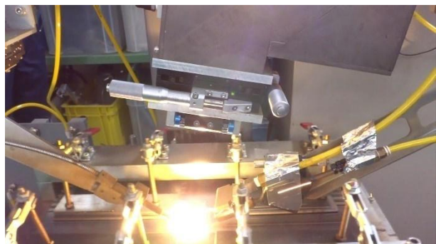
Fig. 1. Comparaison visuelle des projections au cours de la soudure au laser à fibre
