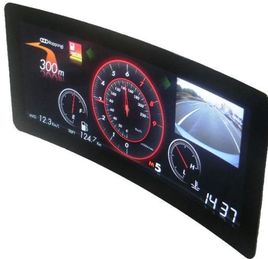
Module TFT-LCD couleur incurvé équipé d'une nouvelle technologie
