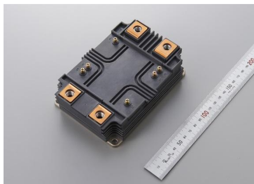
Prototype de module de semi-conducteur de puissance de 6,5 kV, intégralement fabriqué en SiC
