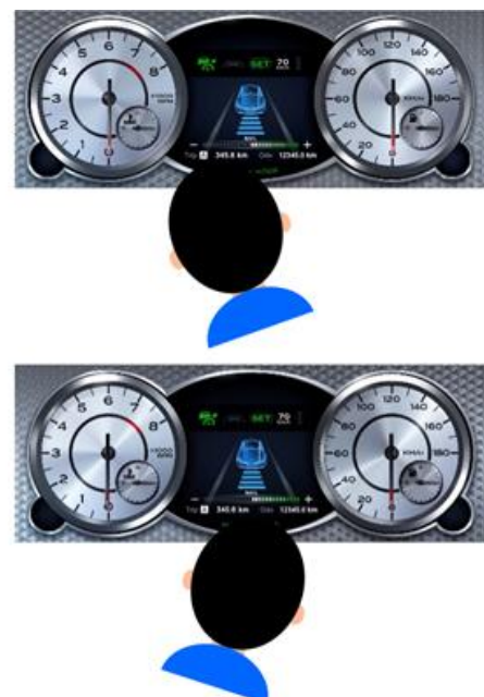
La brillance et l'ombrage changent en temps réel en fonction de l'angle de vision
