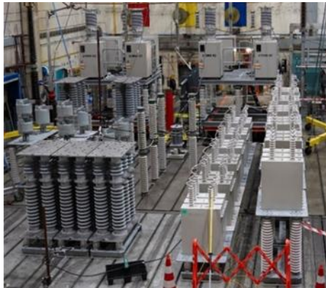
Le prototype de disjoncteur CC mécanique 160 kV utilisé dans les tests
