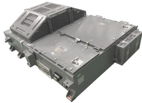
Convertisseur et onduleur montés sur le toit du système de traction avec système de refroidissement naturel par l'air
