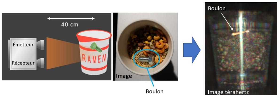
Résultats du test d'inspection non destructif (détection d'un boulon métallique à l'intérieur d'un bol de nouilles)
