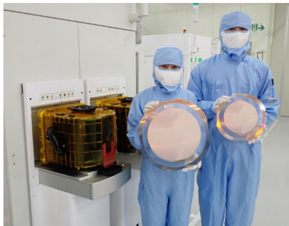
Plaque de silicium 12 pouces et équipement de mesure de résistance, à côté d'une plaque de 8 pouces (à droite) pour référence
